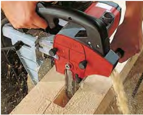
Zapfenlöcher mit dem LS 103 Ec in verschiedenen Abmessungen bis 100 mm.
