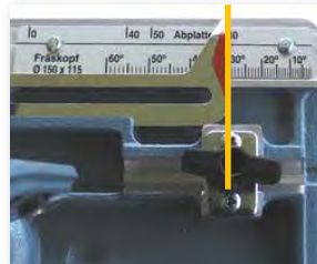
Einfach die Maschine auf Anriss-Kerveneck positionieren.
